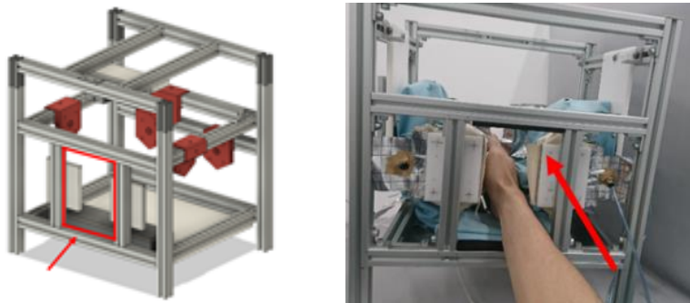
図1 拇指関節リハビリ実験装置の3次元モデル(左)と装置の外観(右)
