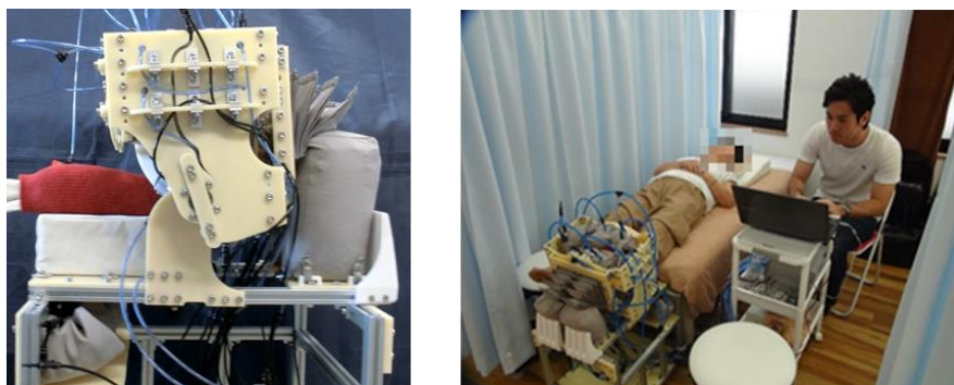
図4 足関節リハビリ運動実験装置(左)とユーザ試験の様子(右)
